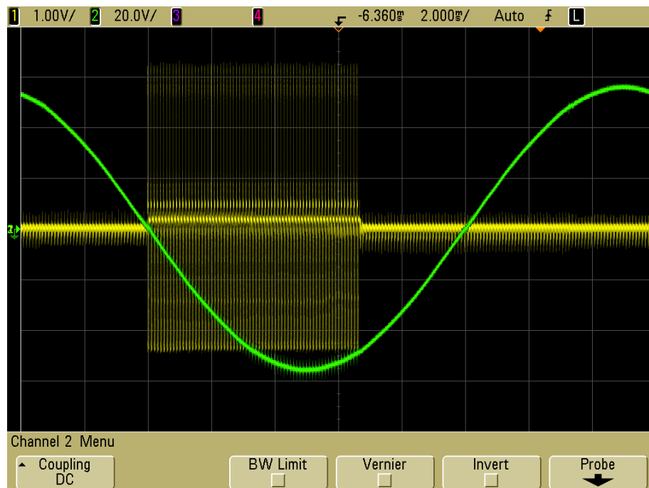
Рисунок 9 – Осциллограмма фазировки полупроводникового преобразователя. Импульс управления тиристором совпадает по фазе с переходом через «0» напряжения «С–А» из «+» в «–»
