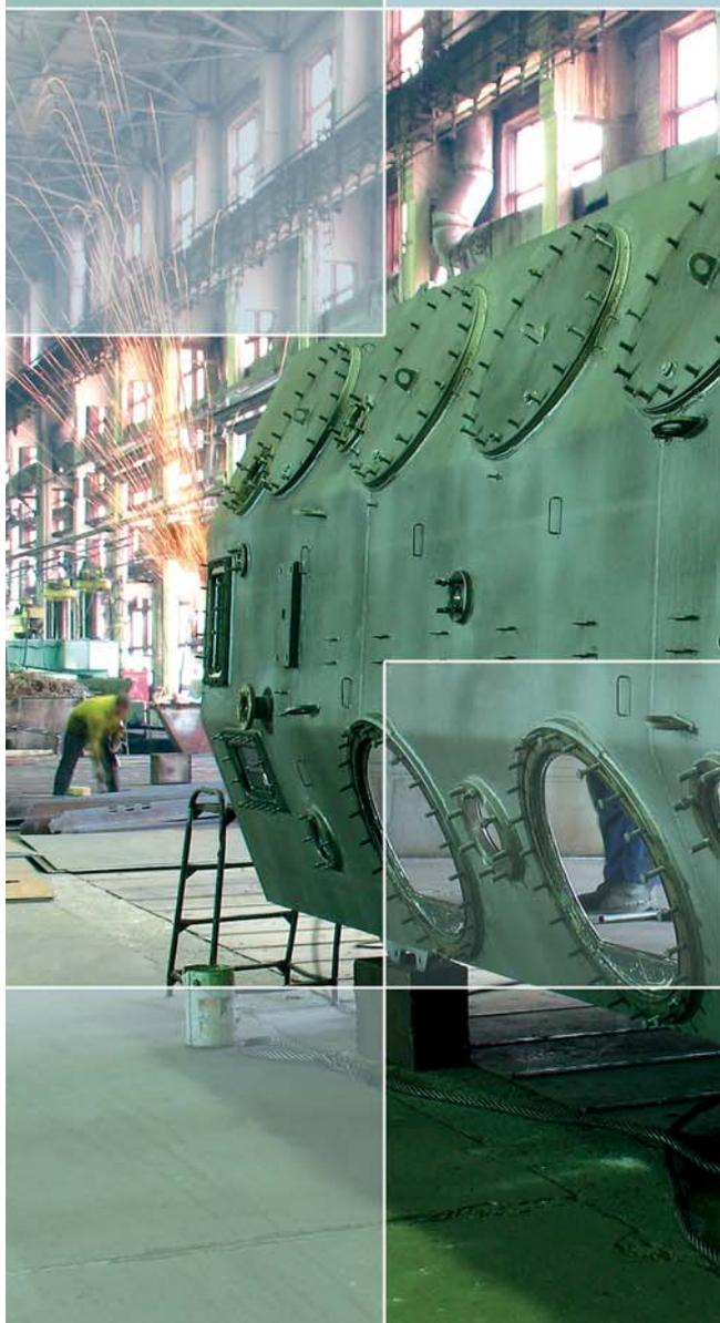
Циклическая прессовка обмоток после термовакуумной обработки обеспечивает повышенную устойчивость обмоток в процессе эксплуатации.
